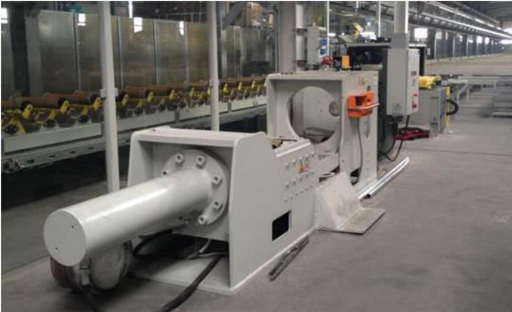
Eine weitere Entwicklung ist die Kombinierte Werkzeugzerlegepresse mit der Pressrestschere. Diese Kombination ist vorteilhaft wenn die Werkzeuge direkt an der Strangpressanlage zerlegt und abgeschert werden sollen.
